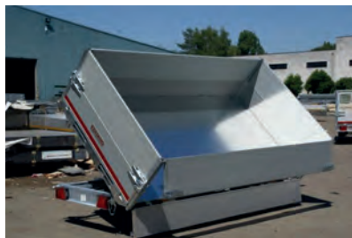
Fig. Sidevægge med tophængsel
