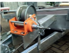
Fig. valg: Vinsj+ stroppebånd + støtte
