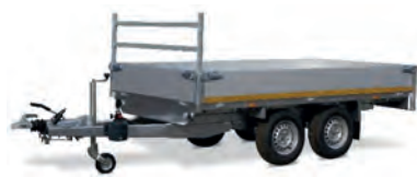
Abb. Stirnwand mit zweistrebigem Rohrrahmen
