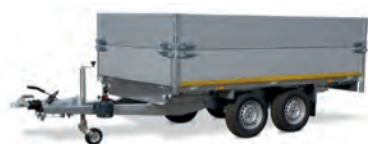
Fig. Extensiones de panel lateral son bisagra en la parte superior
