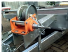
Fig. Mulighed: Spil + kabel + støtte
