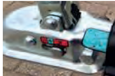
Fig. Färgindikator på påskjutsbromsen
